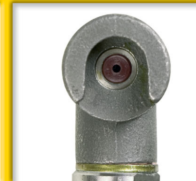
8. Verifique que el sello (NOZCSEAL) este en la posición correcta
