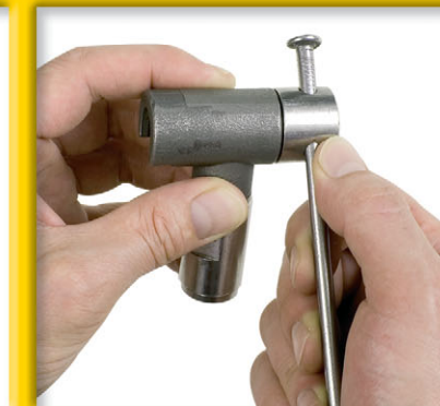
9. Ajuste la parte posterior utilizando el clavo de 6"
