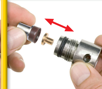
4. Separe la corona (NOZCRING) y el sello (NOZCSEAL) del inserto (NOZCSIN) y de la parte posterior de la boquilla
