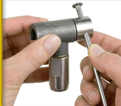
1. Desajuste la parte posterior de la boquilla utilizando un clavo de 6"
