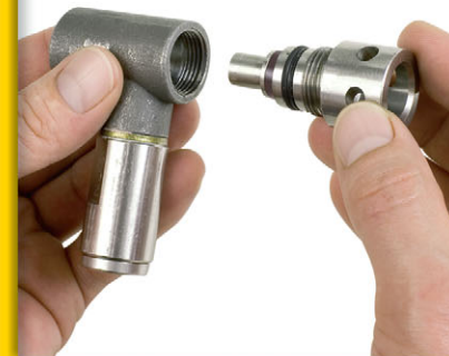
2. Retire todo el conjunto de la parte posterior
