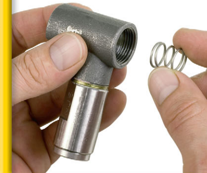
3. Retire el resorte (NOZCSPR) del interior de la boquilla
